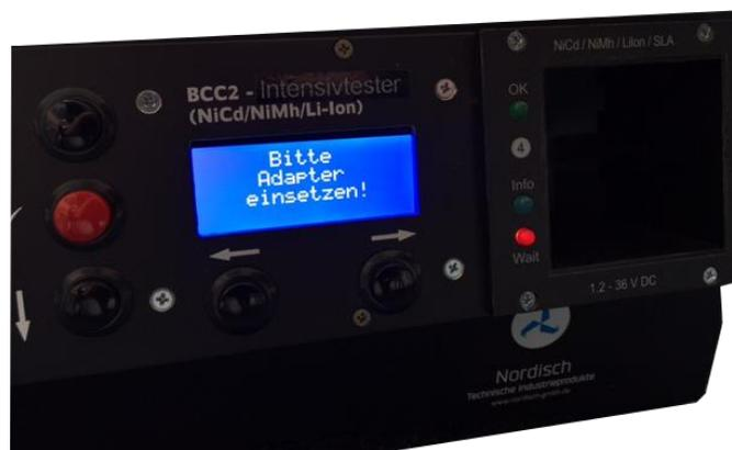
Bild-3, BCC2: Signalgebung ohne eingesetzten Adapter
